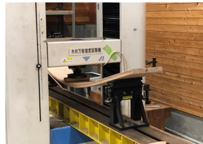
図2 試験の様子 (スパン1500mm試験)
