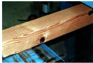
②荷重試験中
