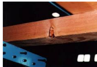
②荷重試験中
